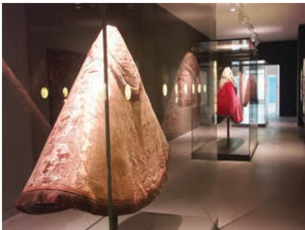
Door de lichtbron ver buiten de vitrine te plaatsen, kan men het lichtniveau op het object tot 50 lux beperken. © FARO
