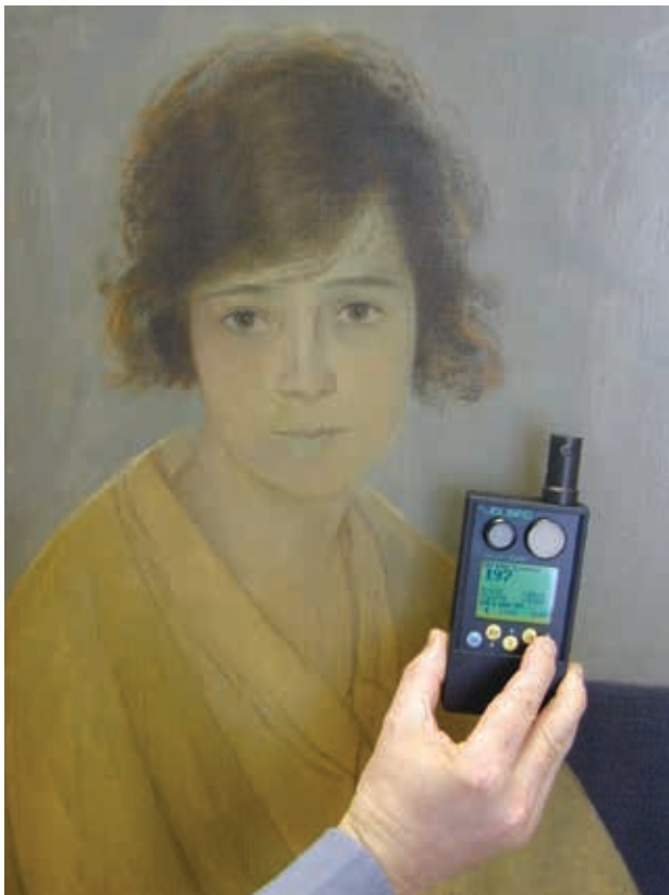
Voorbeeld van een lichtmeting ©FARO
